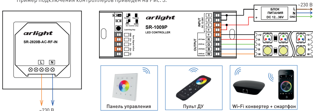
Рис. 3. Схема подключения оборудования на примере контроллера SR-1009P.
