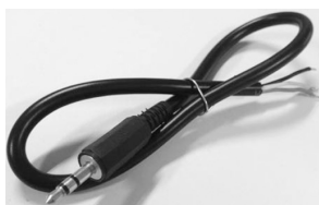
Рис. 2. Сигнальный DMX-кабель. Черный – GND (земля) Красный – Data+ («плюсовой» провод передачи данных) Желтый – Data- («минусовой» провод передачи данных)
