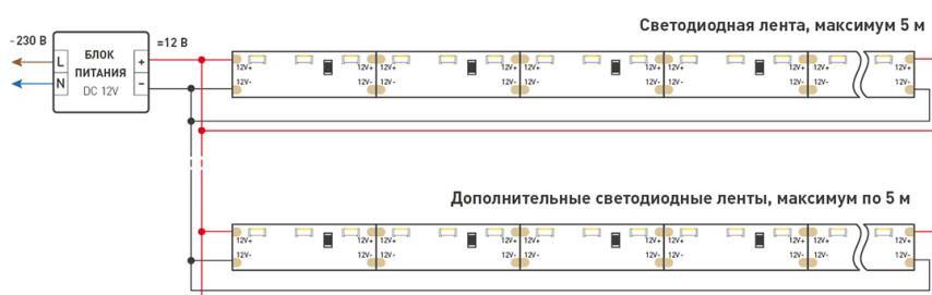
Схема 2. Подключение нескольких светодиодных лент с двух сторон.
